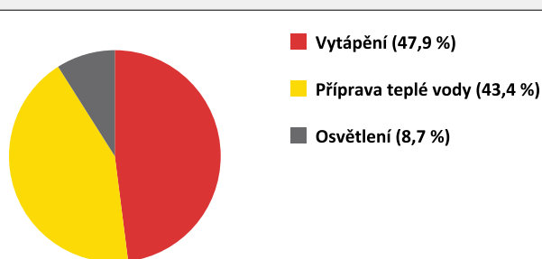
Podíl primární energie z neobnovitelných zdrojů dle účelu
