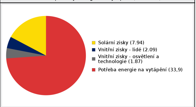
Bilance potřeby energie na vytápění (MWh/rok)
