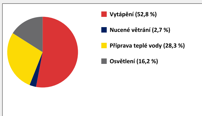
Podíl primární energie z neobnovitelných zdrojů dle účelu
