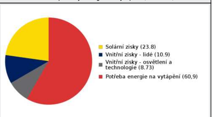
Bilance potřeby energie na vytápění (MWh/rok)
