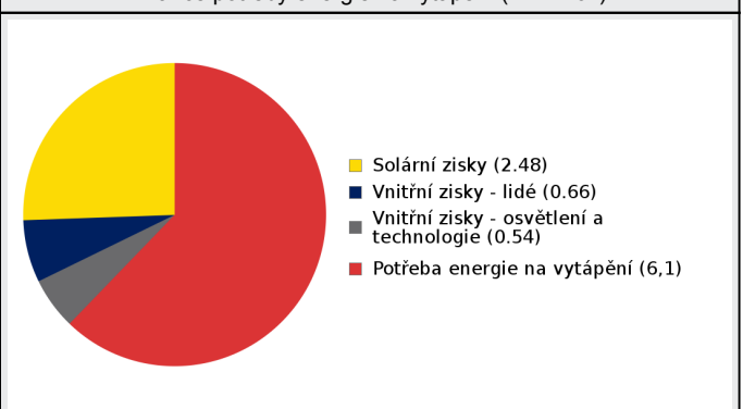
Bilance potřeby energie na vytápění (MWh/rok)
