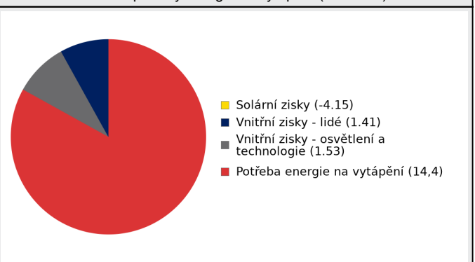
Bilance potřeby energie na vytápění (MWh/rok)
